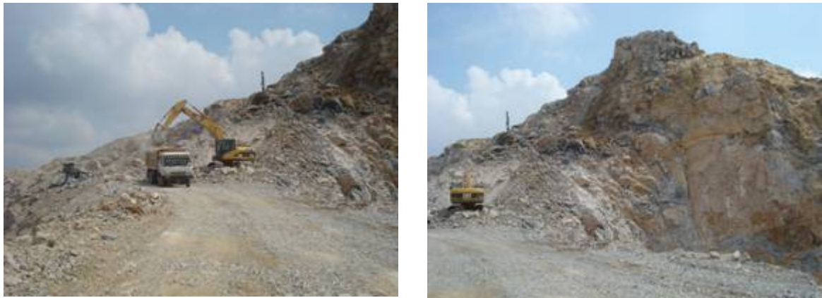
รูปที่ 2 การทำเหมืองบางบริเวณยังเป็นการระเบิดหินแบบหน้าผาระเบิด ซึ่งอาจมีผลต่อความปลอดภัยในการทำเหมือง
